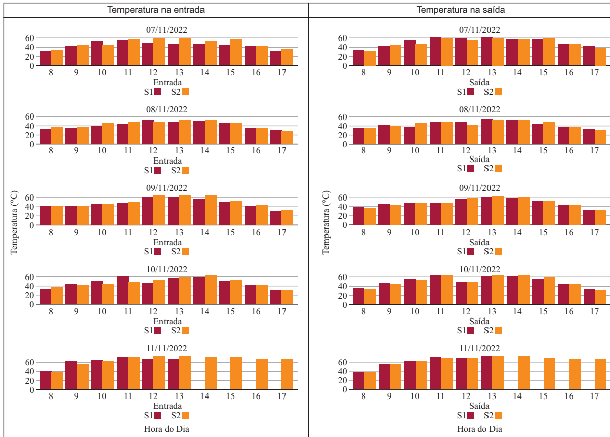
Figura 4 – Temperatura de entrada e saída no secador solar (primavera)
