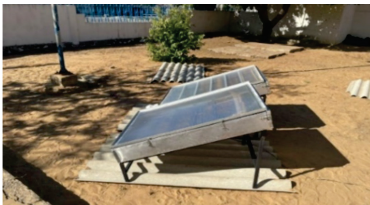
Figura 1 – Protótipo sistema de secagem solar
