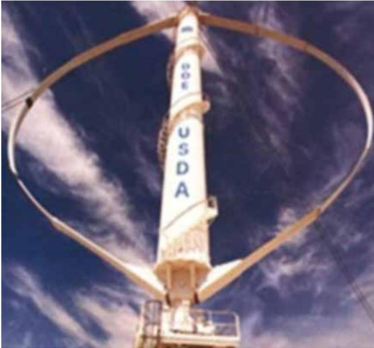
**Foto 2A – Aerogerador Experimental de Eixo Vertical**
