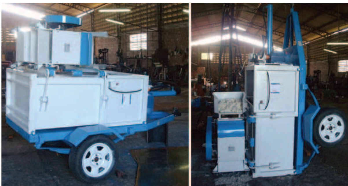
Foto 6 – Máquina Portátil de Beneficiamento de Algodão
