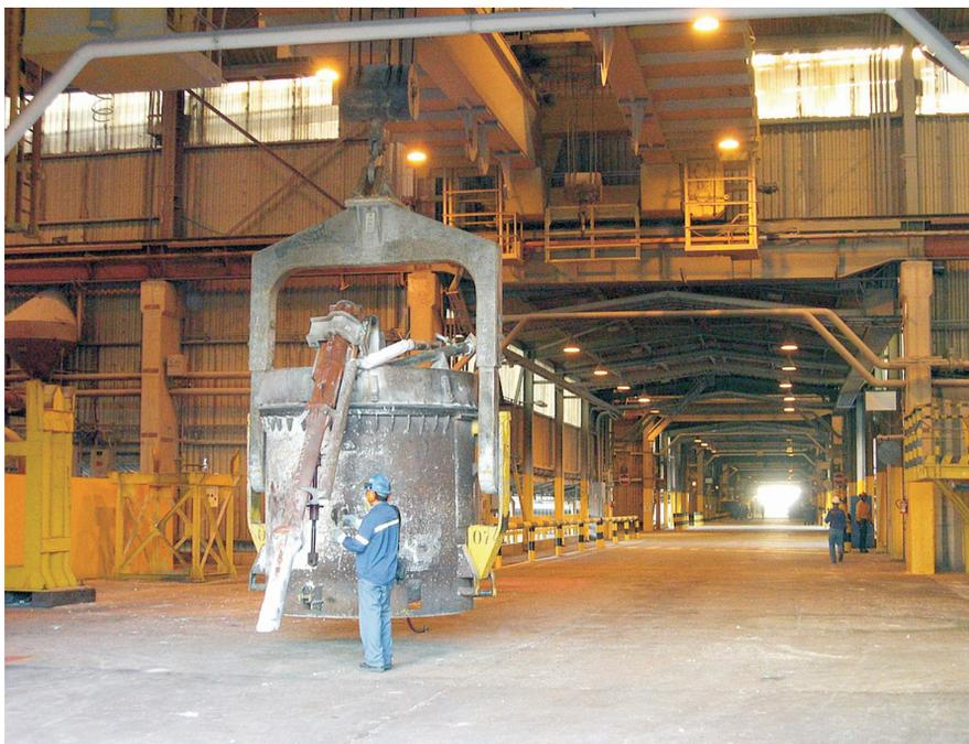
**Foto 1 – Um dos galpões de produção da Alcoa, com um cadinho, para produção dos lingotes de alumínio**
