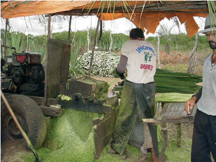
Foto 11 - Puxador e banqueiro no desfibramento de folhas de sisal utilizando o "Motor Paraibano", no município de Conceição do Coité (BA)
