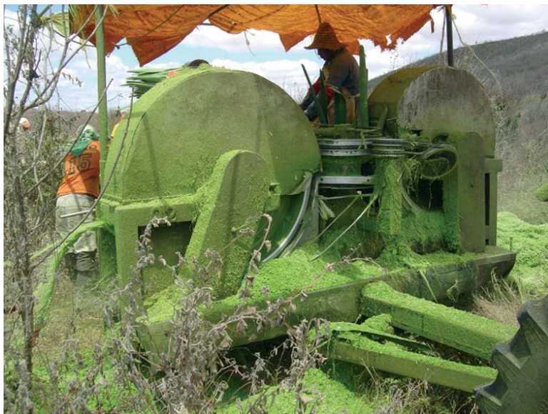
Foto 13 - Desfibradora Faustino, de propriedade da Cosibra, na Fazenda Mandacaru, município de Santa Luz (BA)
