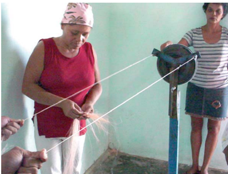
Foto 19 - Confecção de fios a partir da fibra de sisal, em Massabielle, município de Esperança (PB)
