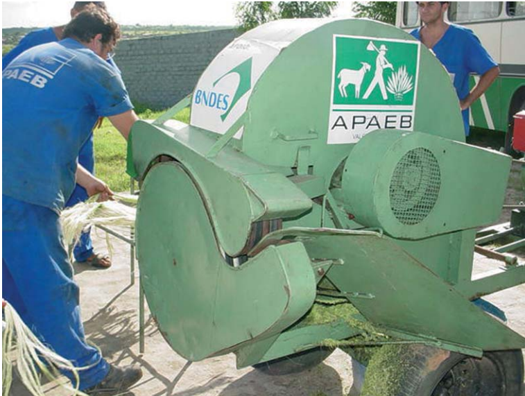
Foto 14 - Protótipo da desfibradora Faustino 3, de propriedade da APAEB, no município de Valente (BA)
