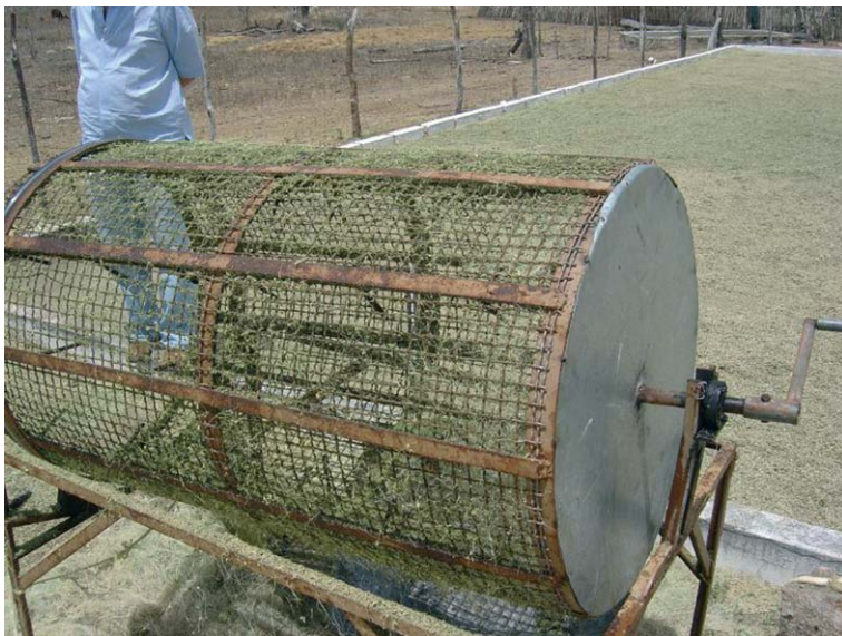
Foto 8 - Peneira rotativa desenvolvida pela Embrapa, em funcionamento no município de Valente (BA)
