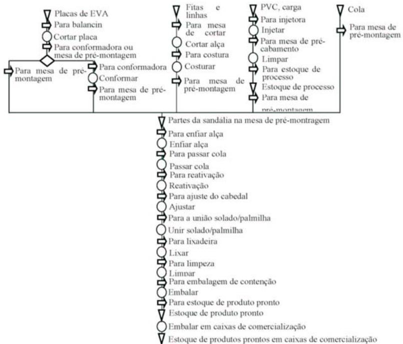
**Figura 4 – Fluxograma do processo produtivo de uma empresa calçadista de pequeno porte**
