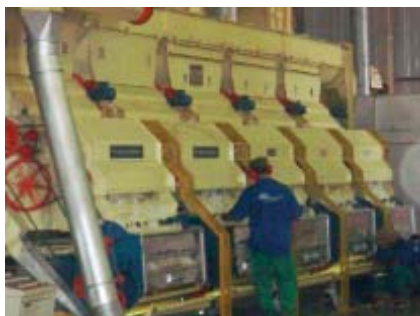
Foto I0 – Máquina descaroadadeira de Algodão. Tasso Fragoso/MA
