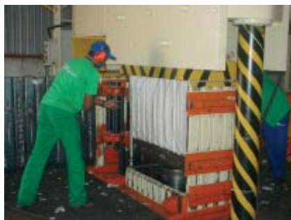
Foto II – Prensa hidráulica para confecção dos fardos. Tasso Fragoso/MA
