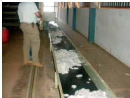
Foto 9 – Esteira que leva o algodão para a sucção. Tasso Fragoso/MA
