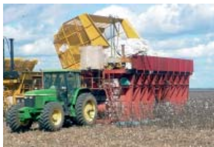
Foto 5 – Prensa na qual o algodão é compactado. Tasso Fragoso/MA
