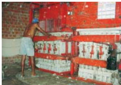
Foto 21 – Prensa para confecção dos fardos. Pequena usina de beneficiamento de Balsas/MA.
