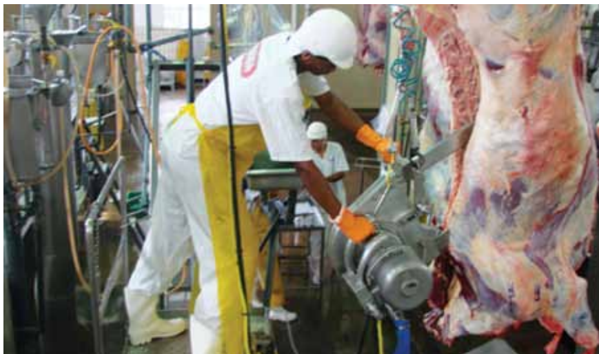
Foto 42 – Separação da carcaça bovina usando serra elétrica em Nanuque (MG)
