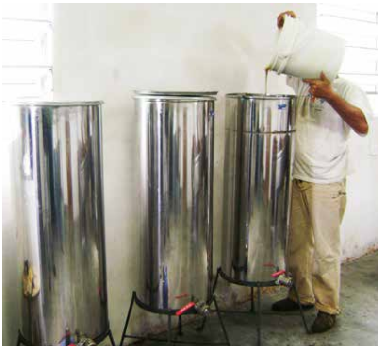
Foto 5 – Tanque para Decantação Usado em Casas de Mel de Menor Porte
