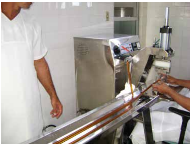
Foto 13 – Fracionamento de Mel em Sachê em Casa de Mel Fonte: BNB/ETENE.
