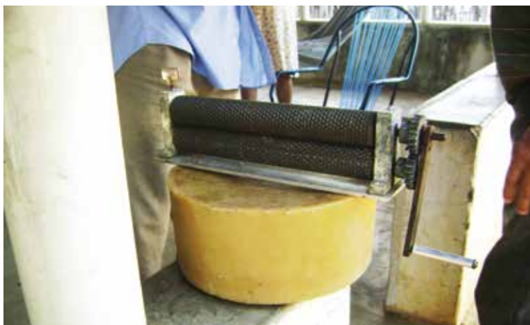
Foto 1 – Cera Bruta e Cilindro para Fabricar a Cera Alveolada para Consumo Próprio do Apicultor – Tabuleiro do Norte/CE
