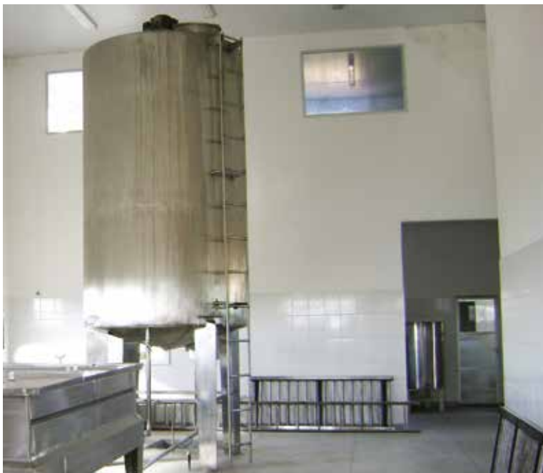
Foto 4 – Tanque para Decantação Usado nas Maiores Unidades de Extração e Beneficiamento
