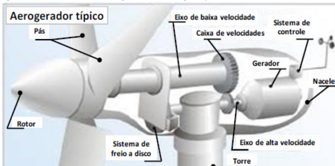
Figura 4 - Partes constituintes de um aerogerador de médio ou grande porte.
